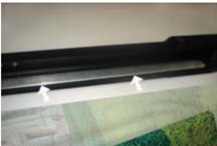
3. Panel mit Motiv nach unten linksbündig auf das Rollende kleben. Naht später zusätzlich mit Klebeband sichern (siehe Zwischenschritt)
